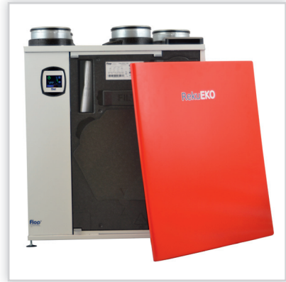
RekuEKO® 380 Wydajność nominalna [m³/h]: 420 (dla 100 Pa). Pobór mocy wentylatorów [W]: 214. Filtry: powietrza świeżego, antyalergiczny F7 (wymienne), powietrza powrotnego G4(zmywalny), nagrzewnica wstępna
