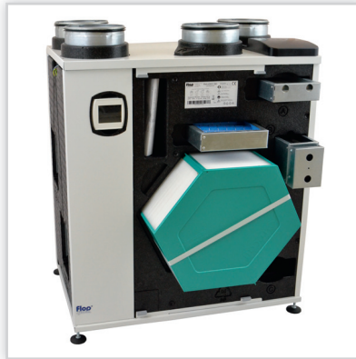
RekuEKO® 550 Wydajność nominalna [m³/h]: 530 (dla 150 Pa). Pobór mocy wentylatorów [W]: 300. Filtry: powietrza świeżego, antyalergiczny F7 (wymienne), powietrza powrotnego G4 (zmywalny), nagrzewnica wstępna.
