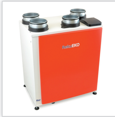
RekuEKO® 190 Wydajność nominalna [m³/h]: 290 (dla 100 Pa). Pobór mocy wentylatorów [W]: 124. Filtry: powietrza świeżego, antyalergiczny F7 (wymienne), powietrza powrotnego G4(zmywalny), nagrzewnica wstępna.
