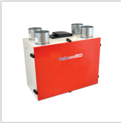
RekuMini EKO® Wydajność nominalna [m³/h]: 100 (dla 160 Pa). Pobór mocy wentylatorów [W]: 156. Filtry: powietrza świeżego i powrotnego G4 (zmywalne), na życzenie F7 (wymienne).
